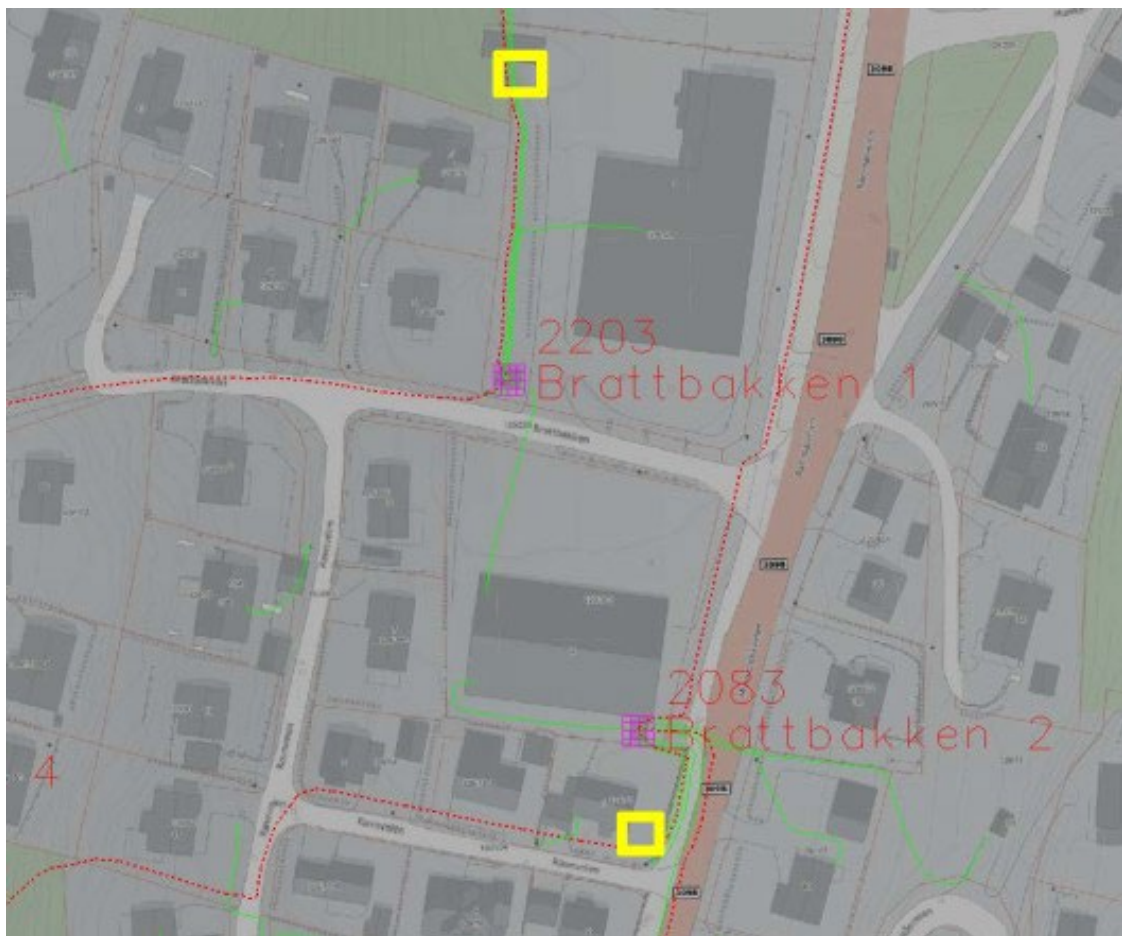
Figur 9-11 Flytting av nettstasjonene NS 2203/2083 Brattbakken 1 og 2.
