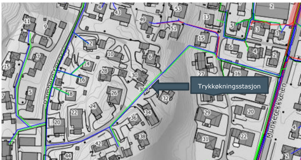
Figur 5-10: Området Ramberg terrasse forsynes med vann via en trykkøkingsstasjon som vist på bildet.
