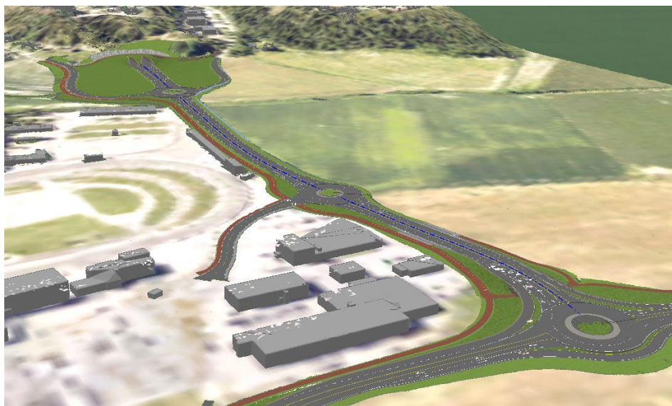
Figur 4-17 Tre rundkjøringer og nytt gang-/ sykkelveisystem inngår i det nye veianlegget.
