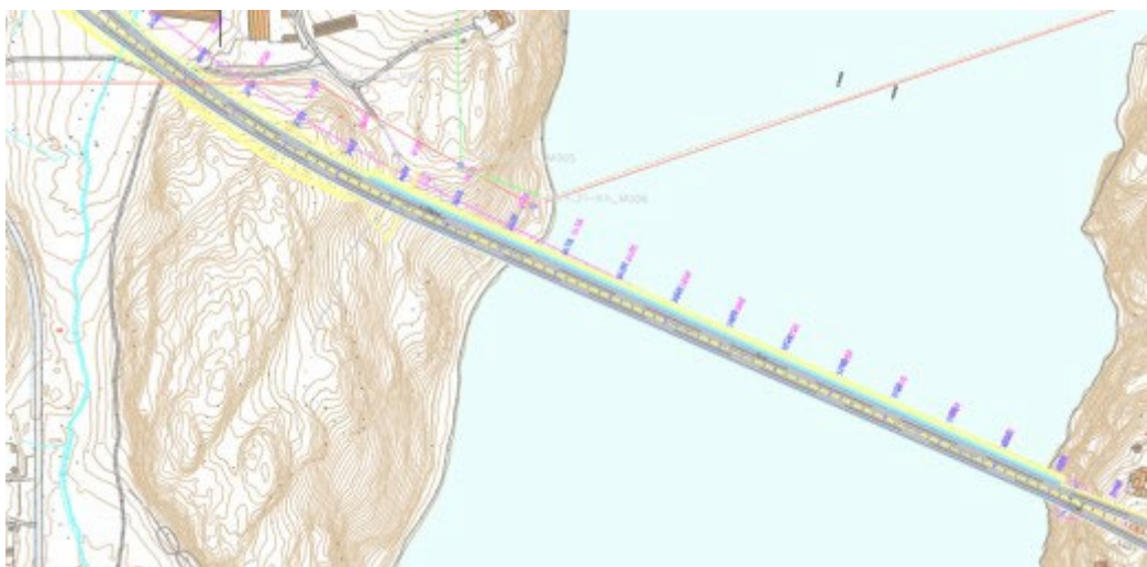
Figur 9-7 Eksisterende høyspentføring sammenstilt med nytt veianlegg
