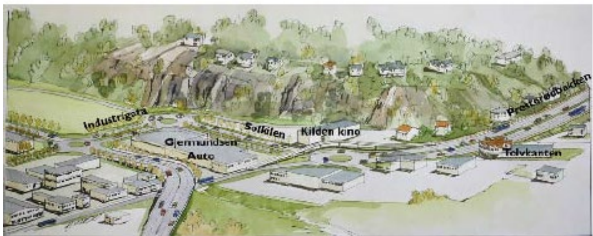
Figur 15: Utvidelse av Presterødbakken til 6 felt inkludert kollektivfelt i hver retning. Ringvei syd i 4 felt og i bru over Halvdan Wilhelmsens allé/Valløveien. Gang- og sykkelveien føres i egen bru over Solkilen.
