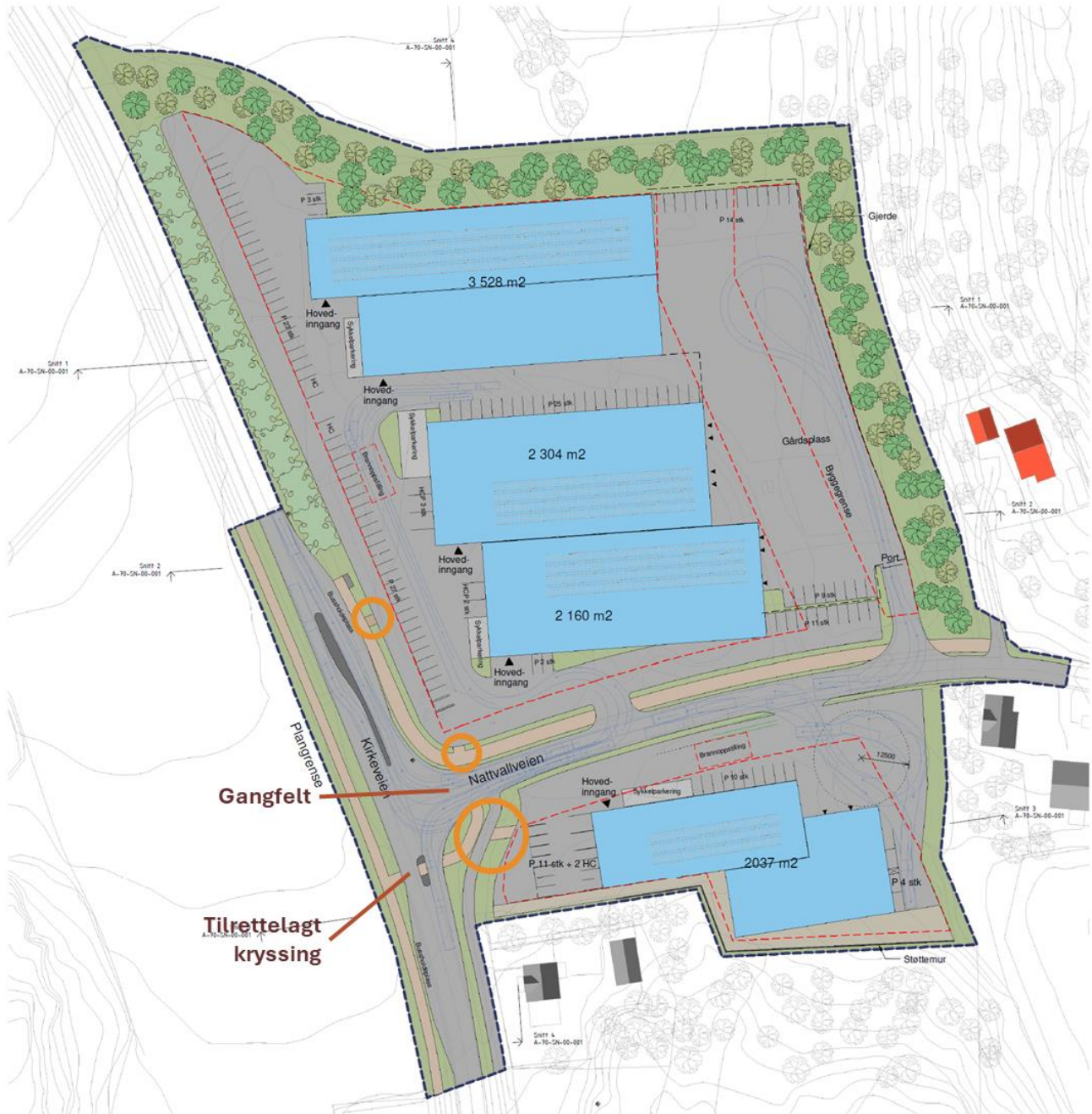
Figur 3-5 Nye koblinger/snarveier til planområdet er markert med oransje sirkler. Nytt gangfelt i Nattvallveien og tilrettelagt kryssing i Kirkeveien er også vist. Foreløpig situasjonsplan per 17.12.2024 (Astrup og Hellern, 2024).
