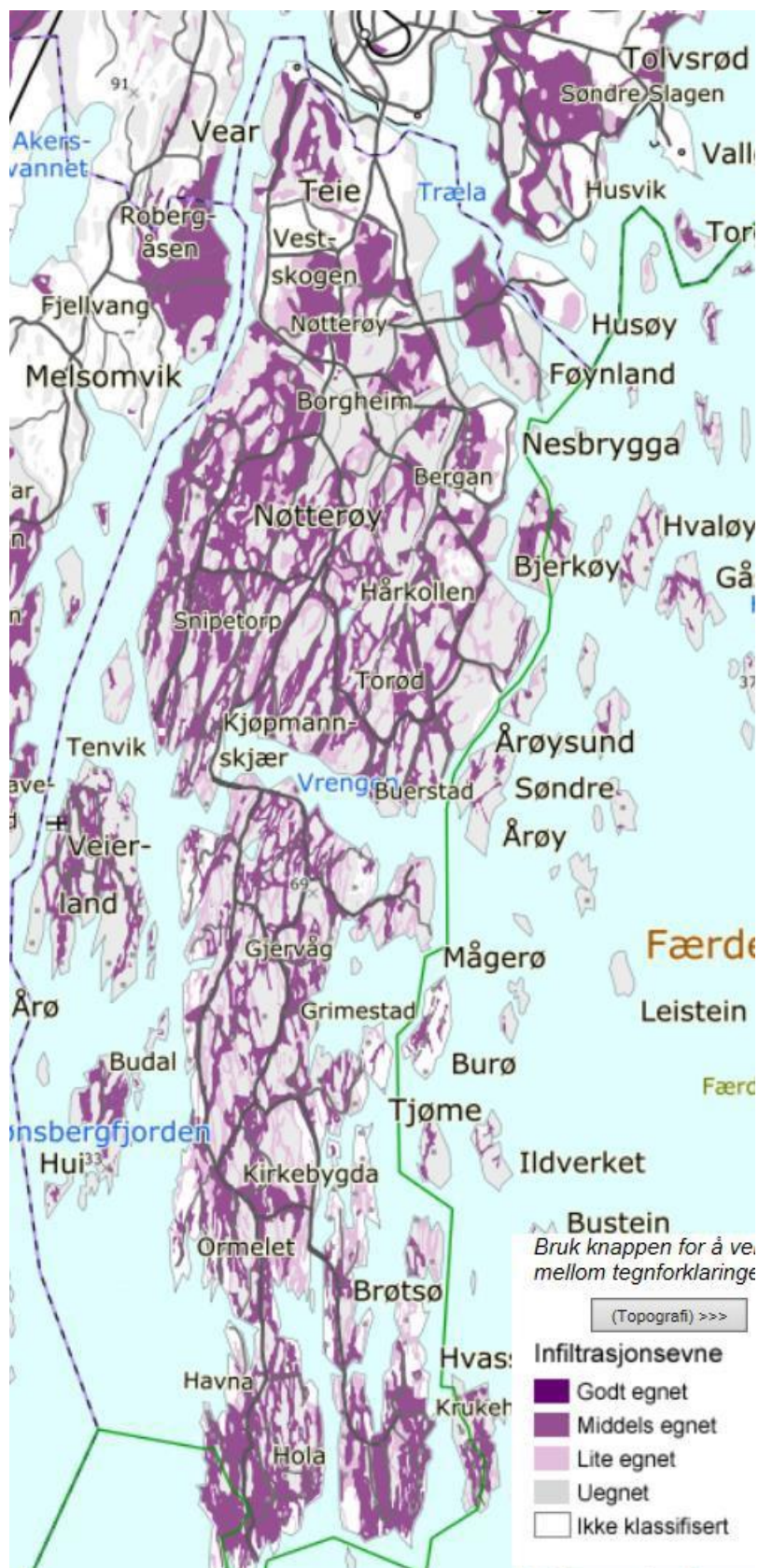
Figur 2: Oversikt over type løsmasseavsetninger og infiltrasjonsevne i Færder kommune.
