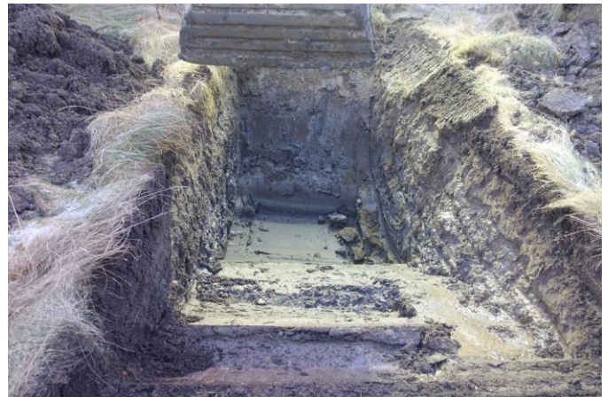
Bilde 4+5. GH1, med de 3 øverste lagene, deretter ren leire nede i bunn utgraving.
