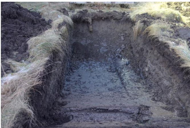
Bilde 4+5. GH1, med de 3 øverste lagene, deretter ren leire nede i bunn utgraving.
