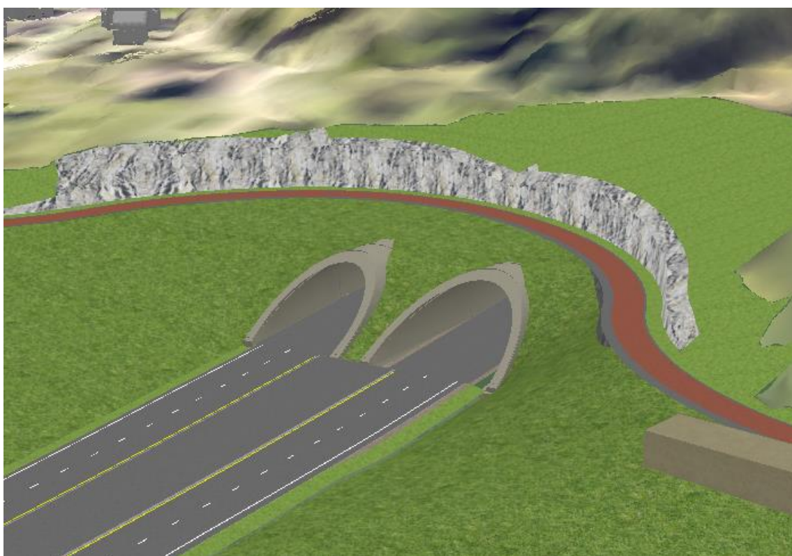
Figur 5-28: Nordre portaler Hogsnestunnelen, på Hogsnes. GS-vei over portalene.
