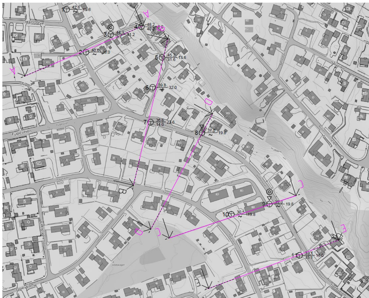
Figur 3: Utklipp fra borplan med påtegnede snitt. Det er regnet stabilitet i snitt D-D.
