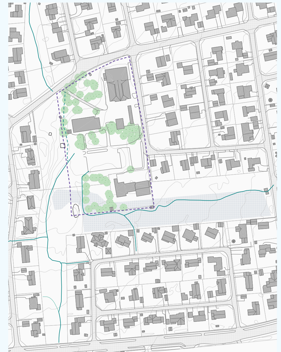
Blå felt viser areal som visuelt fremstår fuktig og som får oppstuvning av vann ved nedbør får oppstuvning av vann.
