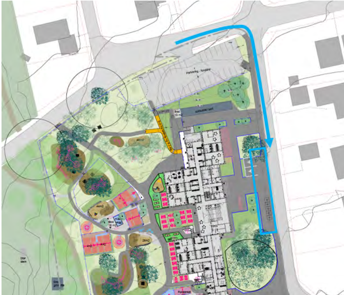
Figur 7-5: Kjøremønster for renovasjonskjøretøy og varelevering
