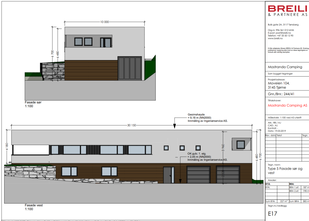
Figur 8 Som bygget-tegning – bygg type 5
