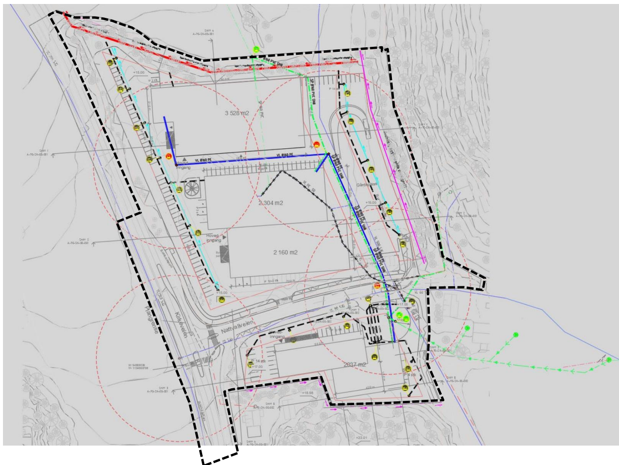
Figur 23: Fremtidig VA- og overvannsløsning i planområdet.
