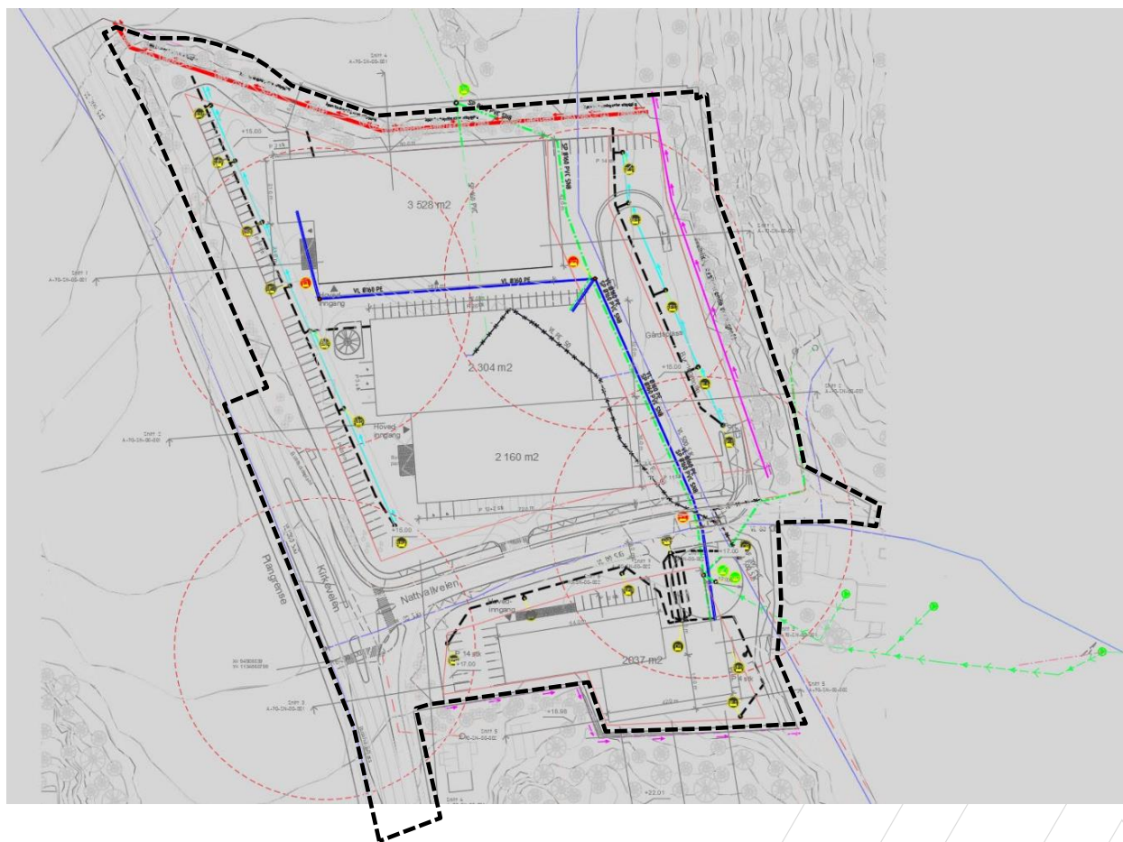
Figur 24: Fremtidig VA- overvannsløsning i planområdet.
